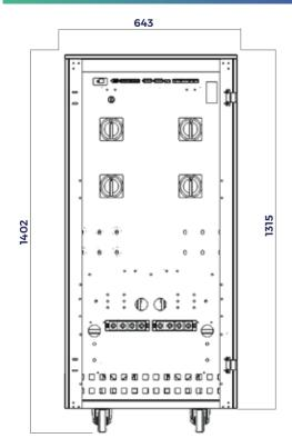
3.3.3 200kVA U1 - 250kVA U1 // U2 // U3 Model Sizes (mm)
